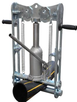
**SQUEEZER 63-200** est un écrase-tube hydraulique, très efficace et utile sur les chantiers pour stopper les fuites de gaz et d'eau dans les conduites en PEHD de  $\varnothing$  63 à 200 mm / SDR11 - SDR17.
