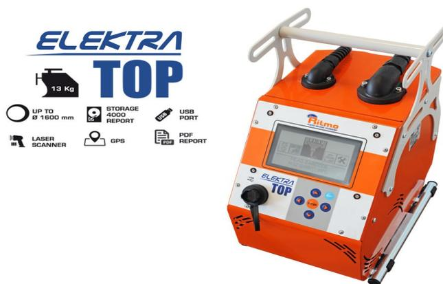
ELEKTRA TOP est une machine à souder polyvalente à hautes performances pour le soudage de tuyaux/raccords pour le transport du gaz, de l'eau et d'autres fluides sous pression (manchons PEHD, PP, PP-R de 8 à 48V). Grand affichage graphique pour simplifier la lecture pendant le réglage et le soudage.
