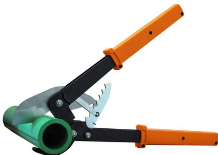
Les **CISAILLES** coupe tubes sont des outils professionnels, essentiels pour la coupe manuelle de tubes en plastique, tels que le PP et PP-R jusqu'au PN 25 ; PEHD, PB et PVDF jusqu'au Ø 75 mm.
