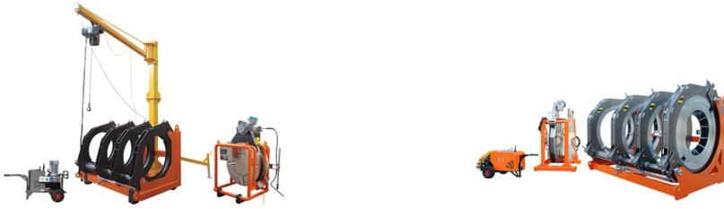
Les modèles DELTA 1000 et DELTA 1200 permettent de souder des coudes, des tés, des croix, des Y et des collets pour brides.
